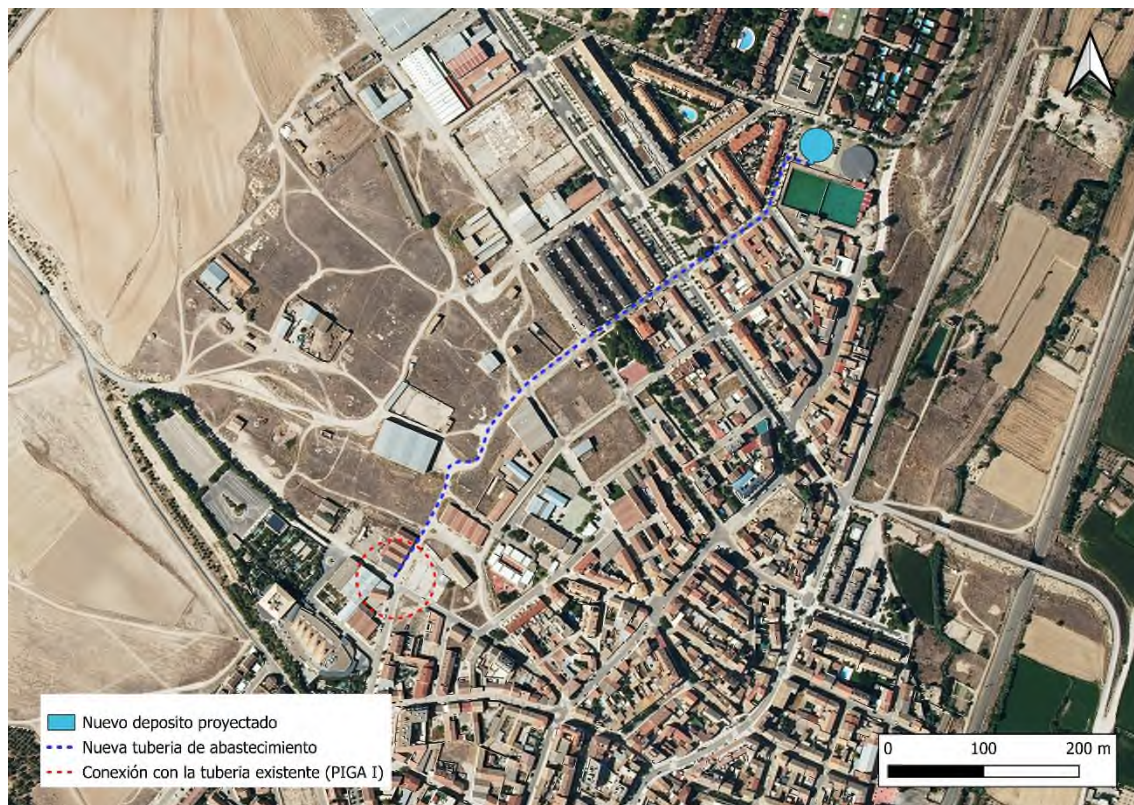
Figura 8. Trazado de la nueva tubería de abastecimiento desde el nuevo depósito hasta la arqueta de conexión con la tubería del PIGA.
